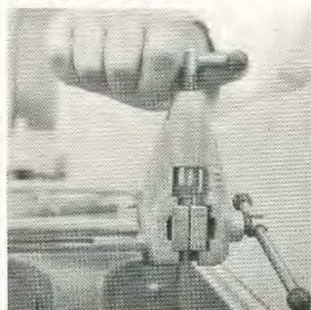
... Druckspindel drehen. Bördel F wird geformt
