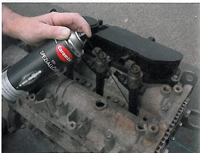
Der EDI-Speziallöser kühlt den Rost am Sitz von festgerosteten Einspritzdüsen auf -30 °C ab und bricht ihn auf.
