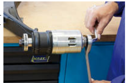
Auspressen des Silentlagers mit Hilfe des entsprechenden Werkzeugs. Bild: Hazet
