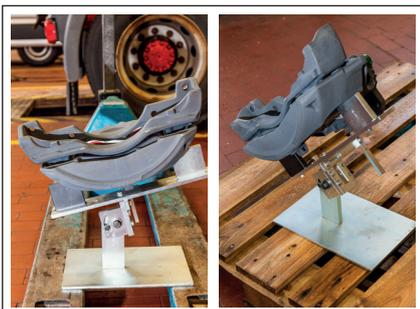
**HINWEIS!** 4972-2 Schwenklager zu Demontage und Montage von Bremssätteln an LKW, Omnibus, Trailer, und Anhängerachsen, welche in diagonaler „Uhrzeigerstellung zwischen 20:00 und 17:00 Uhr“ verbaut sind.
