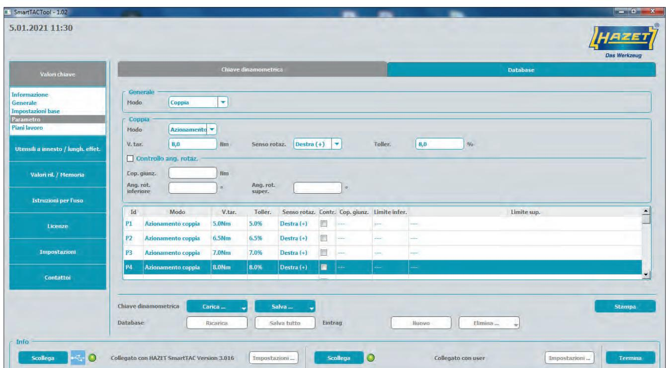
Nella tab "Parametro" è possibile creare, modificare ed elaborare i parametri. Tramite "Carica" è possibile visualizzare anche i parametri preimpostati della chiave dinamometrica combinata coppia ed angolo di rotazione HAZET SmartTAC. I parametri creati possono essere utilizzati nei piani di lavoro.
