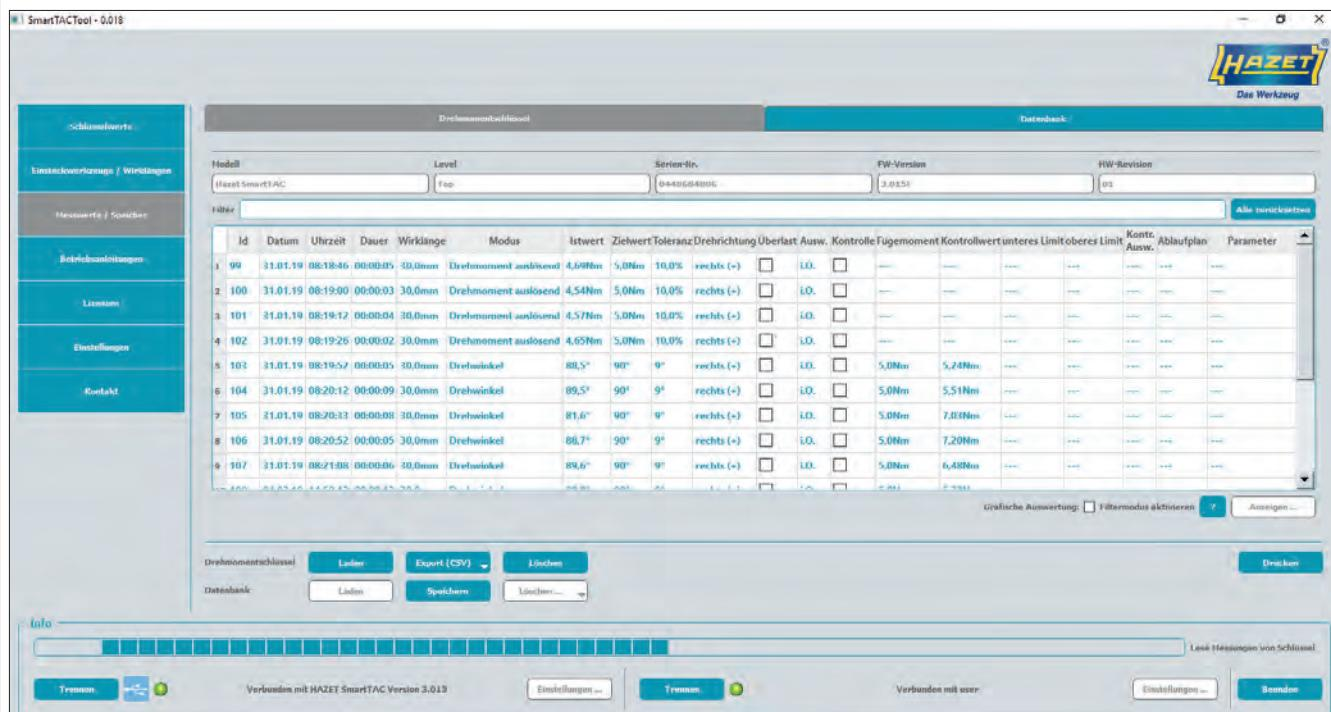
Im Reiter „Messwerte / Speicher“ können Sie über den Button „Laden“ die im HAZET SmartTAC Drehmoment- und Drehwinkelschlüssel gespeicherten Messergebnisse laden.
