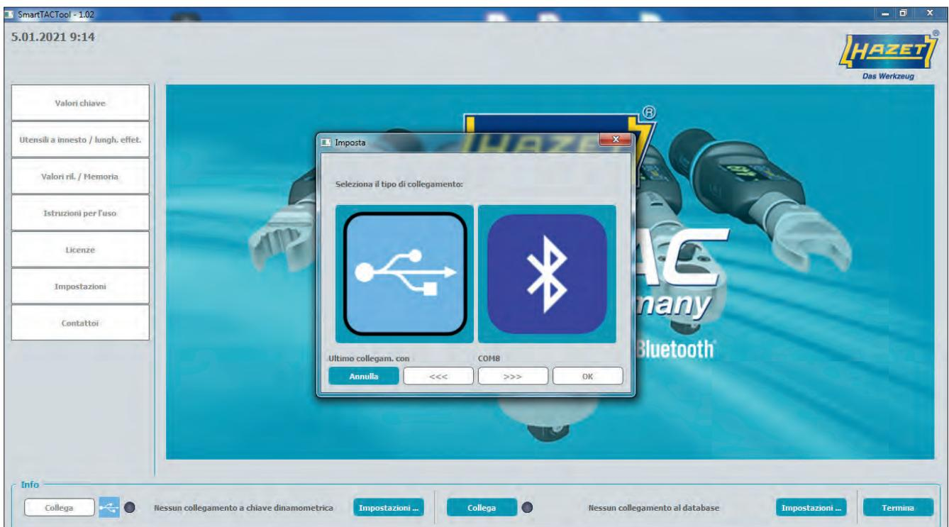
Avviare l'applicazione. Prima di poter utilizzare il software bisogna creare il collegamento con la propria chiave dinamometrica combinata coppia ed angolo di rotazione HAZET SmartTAC. Selezionare tramite il pulsante "Impostazioni" sul lato sinistro il tipo di collegamento per collegarsi con la propria chiave HAZET sTAC.
