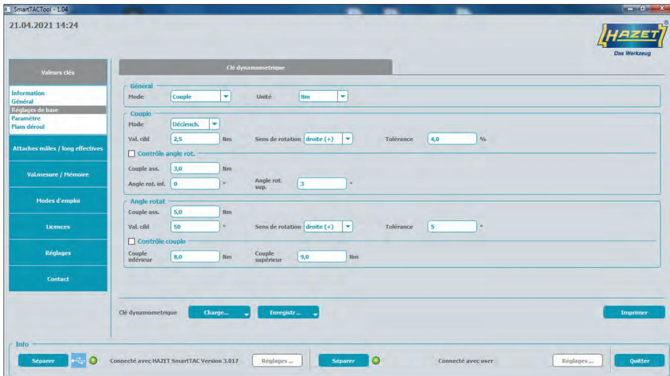
Les valeurs de réglage de la clé dynamométrique à serrage couple et angle HAZET SmartTAC sont affichées dans l'onglet « Réglages de base ». Vous pouvez les modifier ici et programmer votre clé dynamométrique à serrage couple et angle HAZET SmartTAC en fonction de vos tâches.
