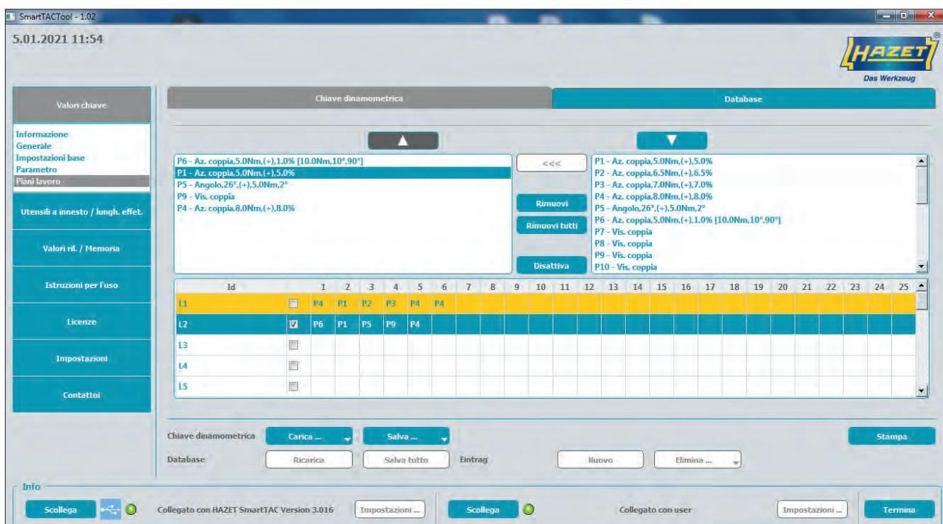
Se si desidera cambiare l'ordine di un parametro nel piano di lavoro, è possibile spostare il parametro con entrambe le frecce in alto e in basso.
