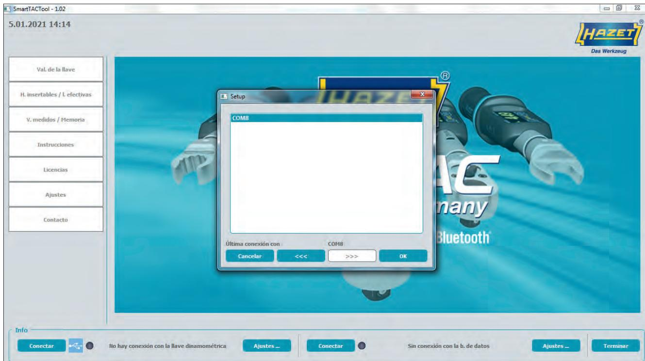
Seleccione el puerto USB apropiado para conectar la llave dinamométrica / medidora de ángulos de giro HAZET SmartTAC.
