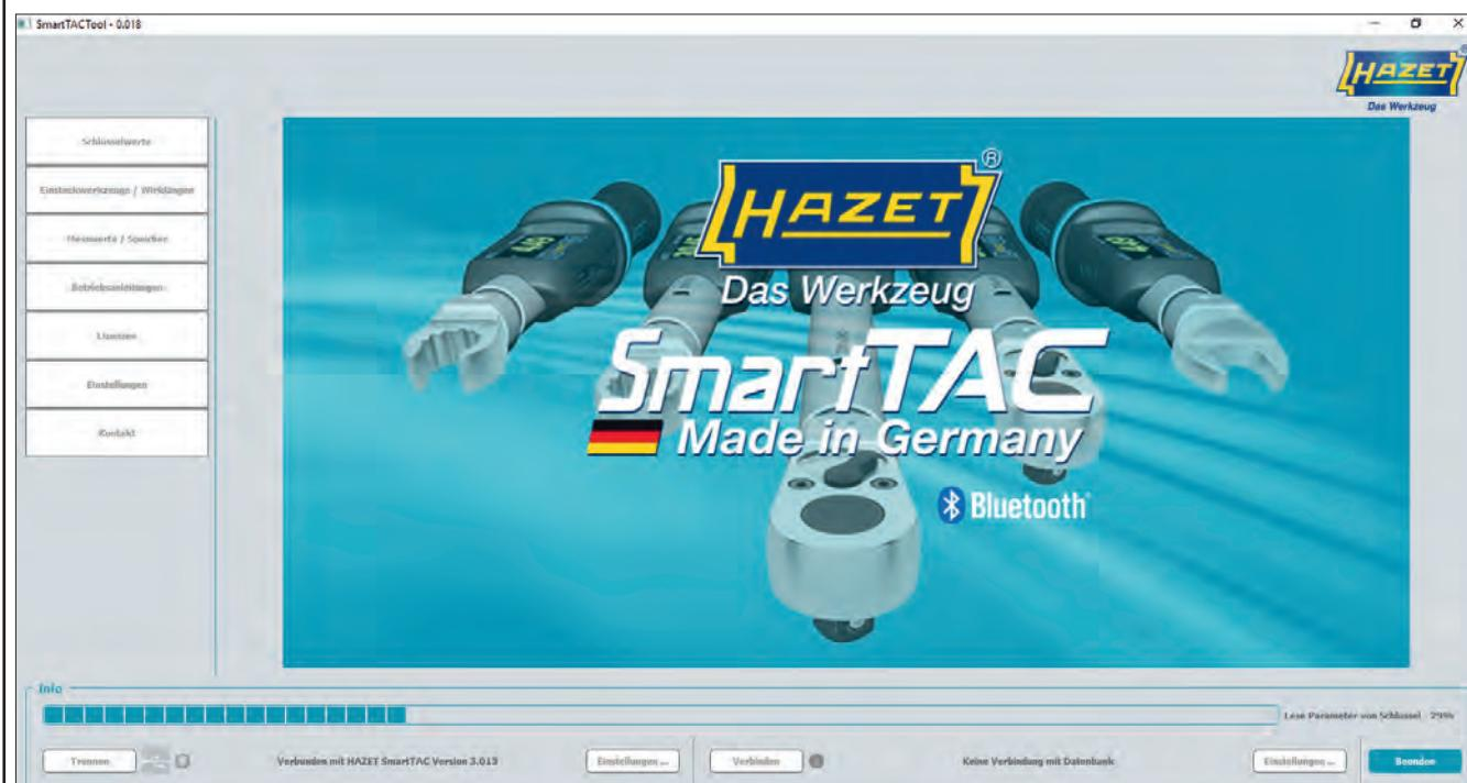
Haben Sie den Port ausgewählt, verbinden Sie Ihren HAZET SmartTAC Drehmoment- und Drehwinkelschlüssel über den Button auf der linken Seite.
