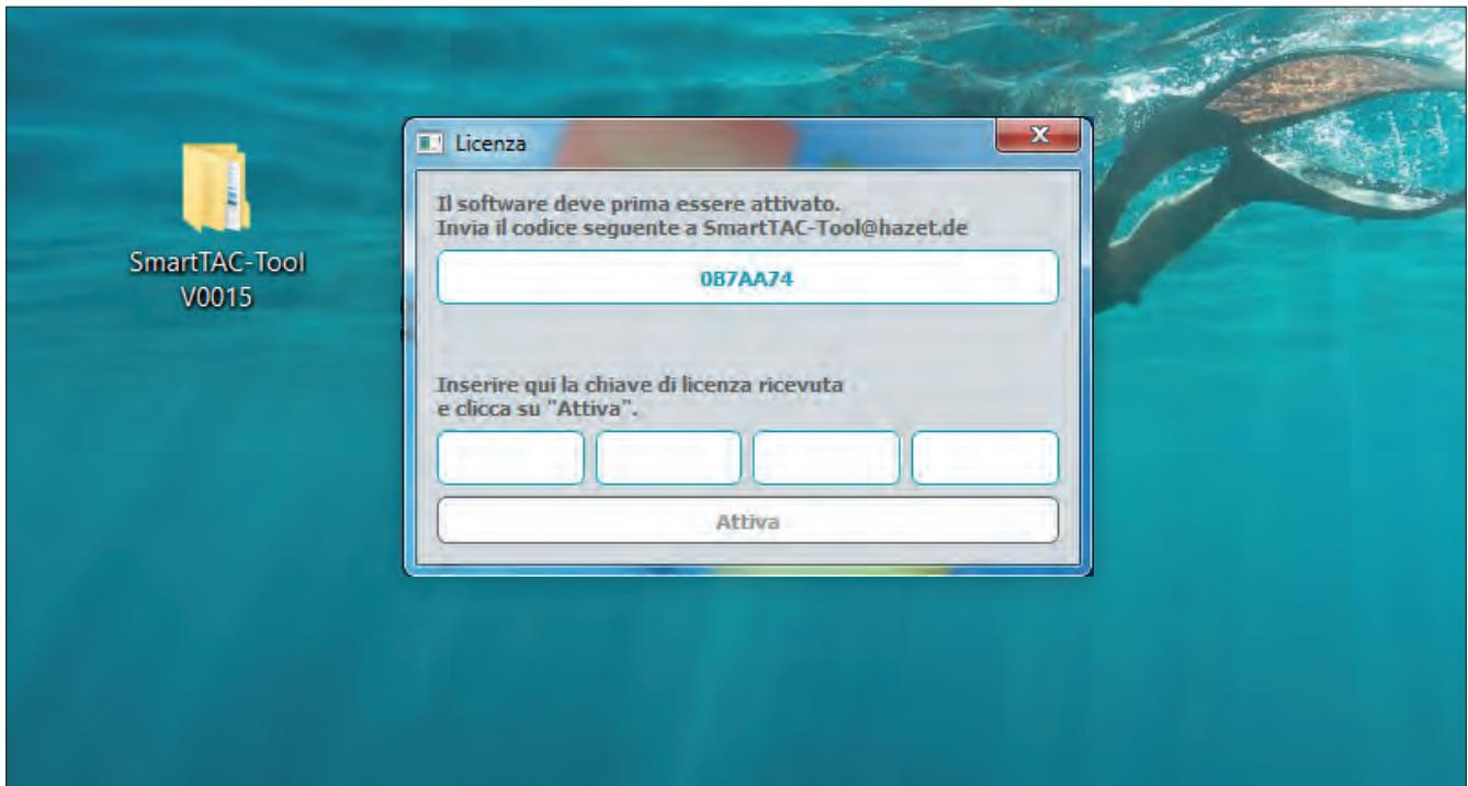
Quando si avvia l'applicazione per la prima volta è necessario attivare il software. Pertanto inviare il codice visualizzato all'indirizzo email **SmartTAC-Tool@hazet.de**. Si riceverà il codice di attivazione con cui è possibile avviare il software.
