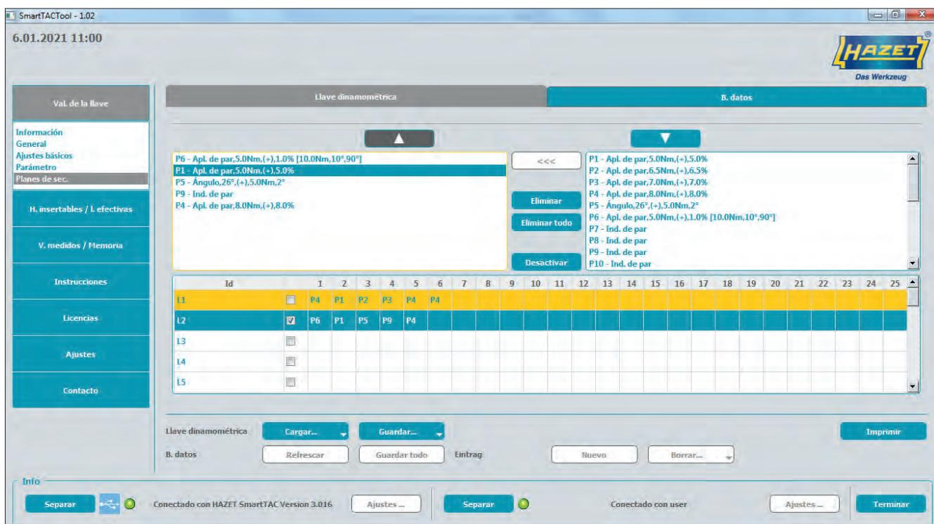
Si desea cambiar el orden de un parámetro en el plan de secuencia, puede mover el parámetro hacia arriba y hacia abajo usando las dos flechas.
