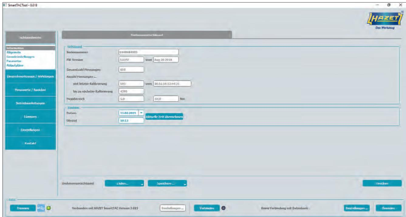
Im Reiter „Schlüsselwerte“ erhalten Sie alle Information über den HAZET SmartTAC Drehmoment- und Drehwinkelschlüssel. Unter „Information“ werden Seriennummer, Messbereich usw. angezeigt
