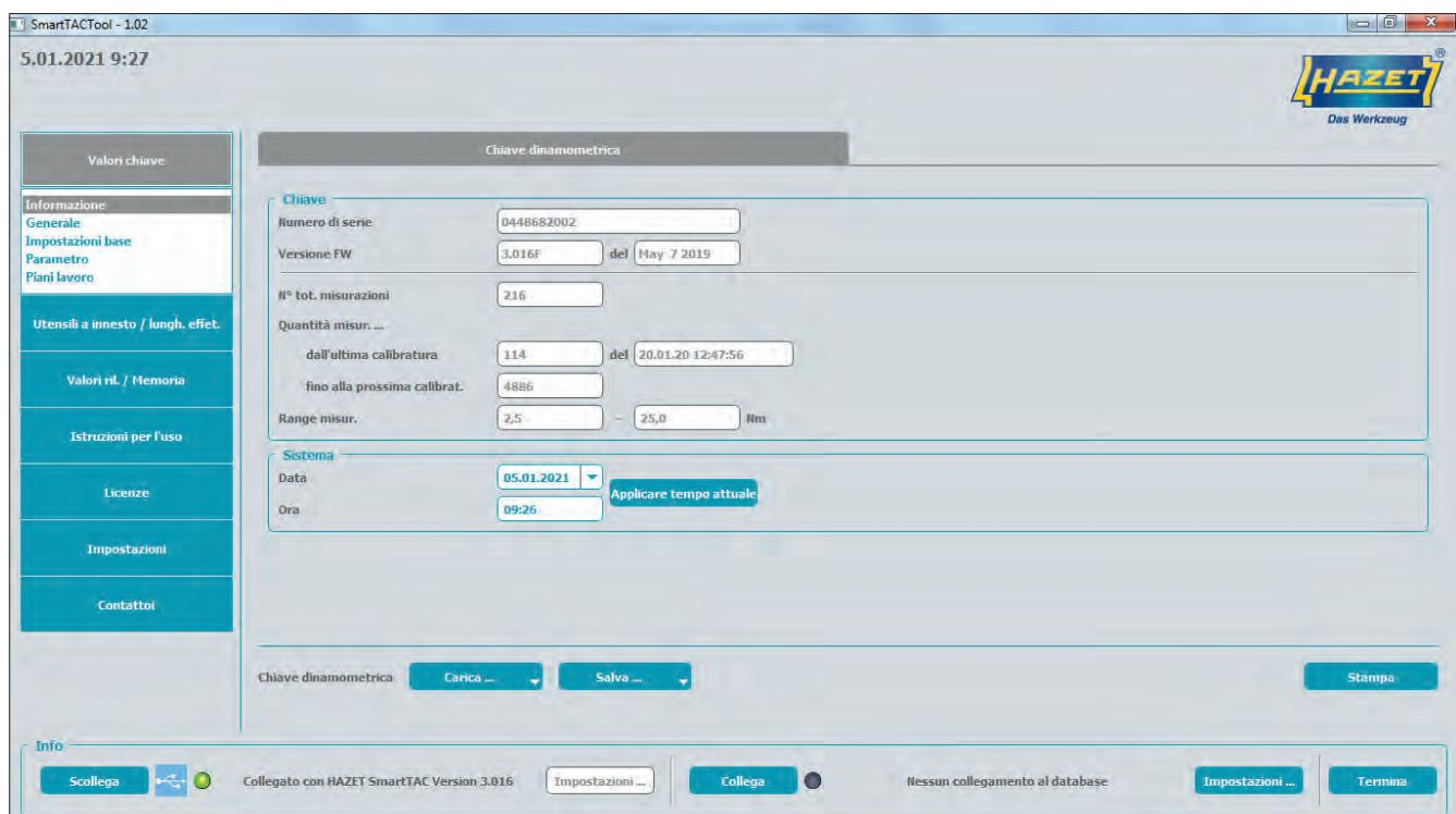
La tab "Valori chiave" mostra tutte le informazioni sulla chiave dinamometrica combinata coppia ed angolo di rotazione HAZET SmartTAC. Sotto "Informazione" vengono visualizzati numero di serie, range di misurazioni, ecc.
