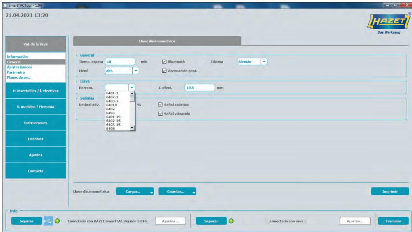
En la pestaña "General" verá, entre otras cosas, el tiempo de espera y la configuración del idioma. Aquí tiene la posibilidad de seleccionar la longitud efectiva de la herramienta insertable.
