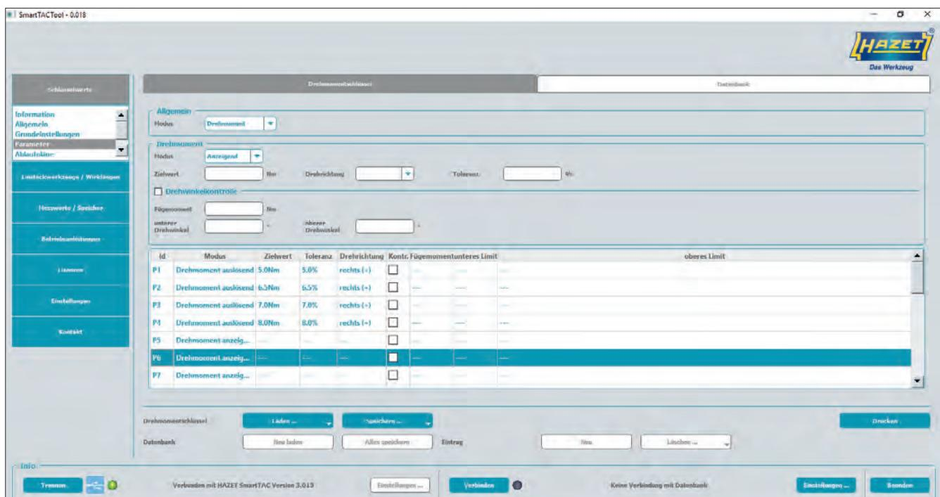
Im Reiter „Parameter“, können Sie Parameter anlegen, bearbeiten und ändern. Sie können auch über Laden die voreingestellten Parameter des HAZET SmartTAC Drehmoment- und Drehwinkelschlüssel anzeigen lassen. Angelegte Parameter können Sie in Ablaufplänen verwenden.
