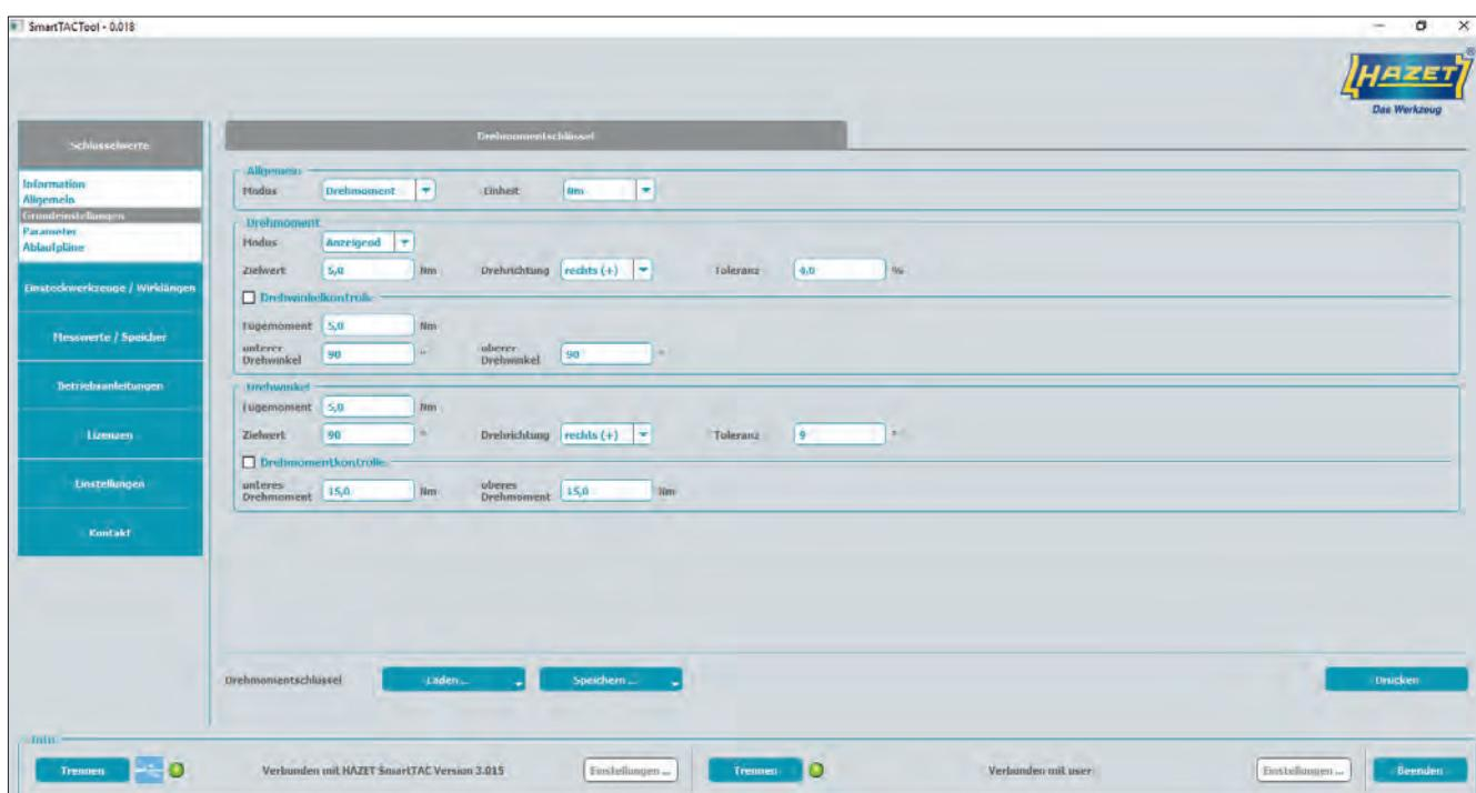
Im Reiter „Grundeinstellung“, werden Ihnen die Einstellwerte des HAZET SmartTAC Drehmoment- und Drehwinkelschlüssel angezeigt. Diese können Sie direkt ändern und Ihren HAZET SmartTAC Drehmoment- und Drehwinkelschlüssel für Ihre Arbeitstafel programmieren.
