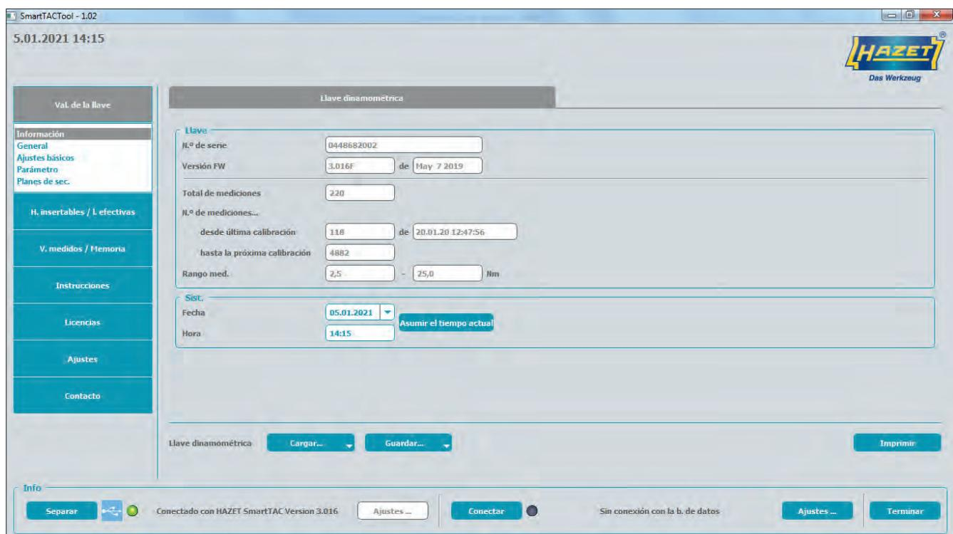
En la pestaña "Valores de la llave" encontrará toda la información sobre la llave dinamométrica / medidora de ángulos de giro HAZET SmartTAC. El número de serie, el rango de medición, etc. se muestran en "Información"
