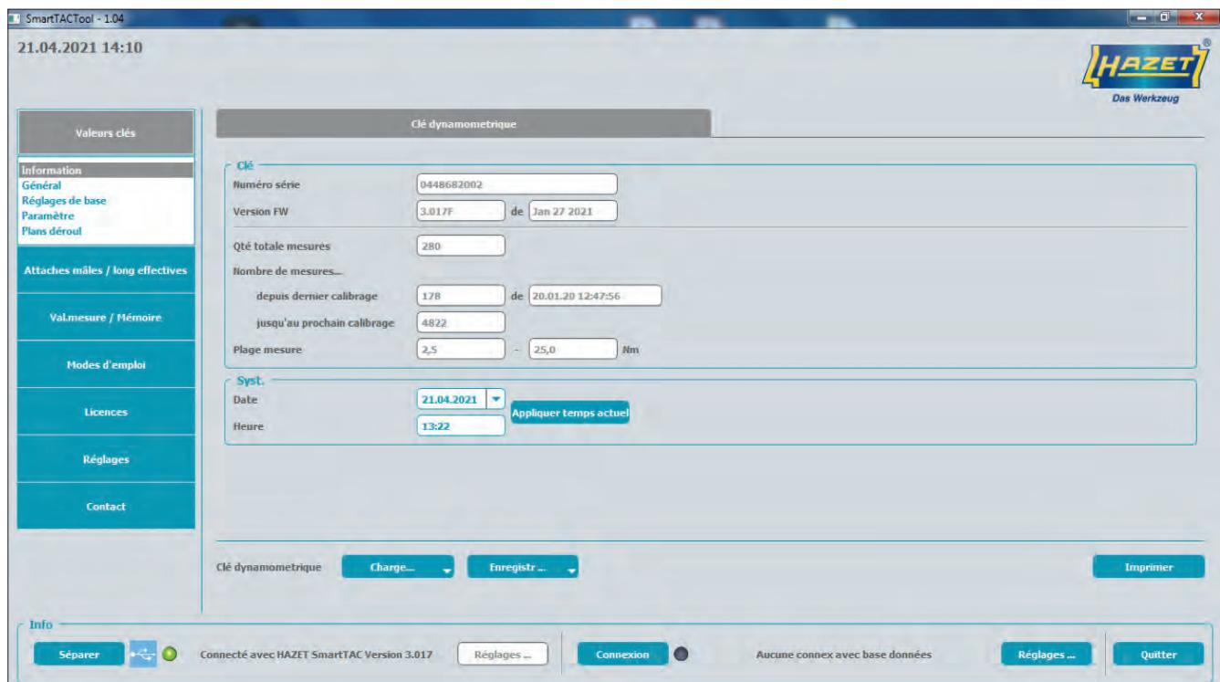
Dans l'onglet « Valeurs clés », vous trouverez toutes les informations sur la clé dynamométrique à serrage couple et angle HAZET SmartTAC. Le numéro de série, la plage de mesure etc. sont affichés sous « Information »
