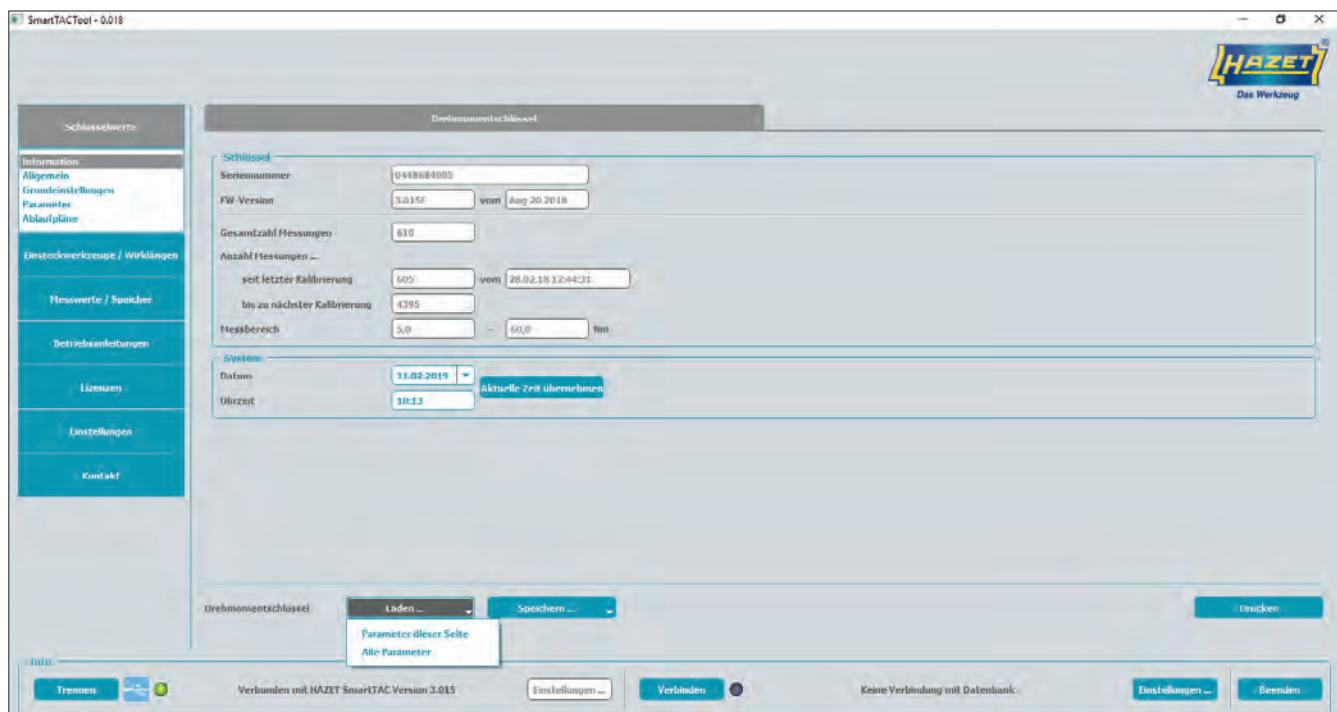
Über Laden, können Sie eingestellte Parameter vom Schlüssel laden und anzeigen lassen.
