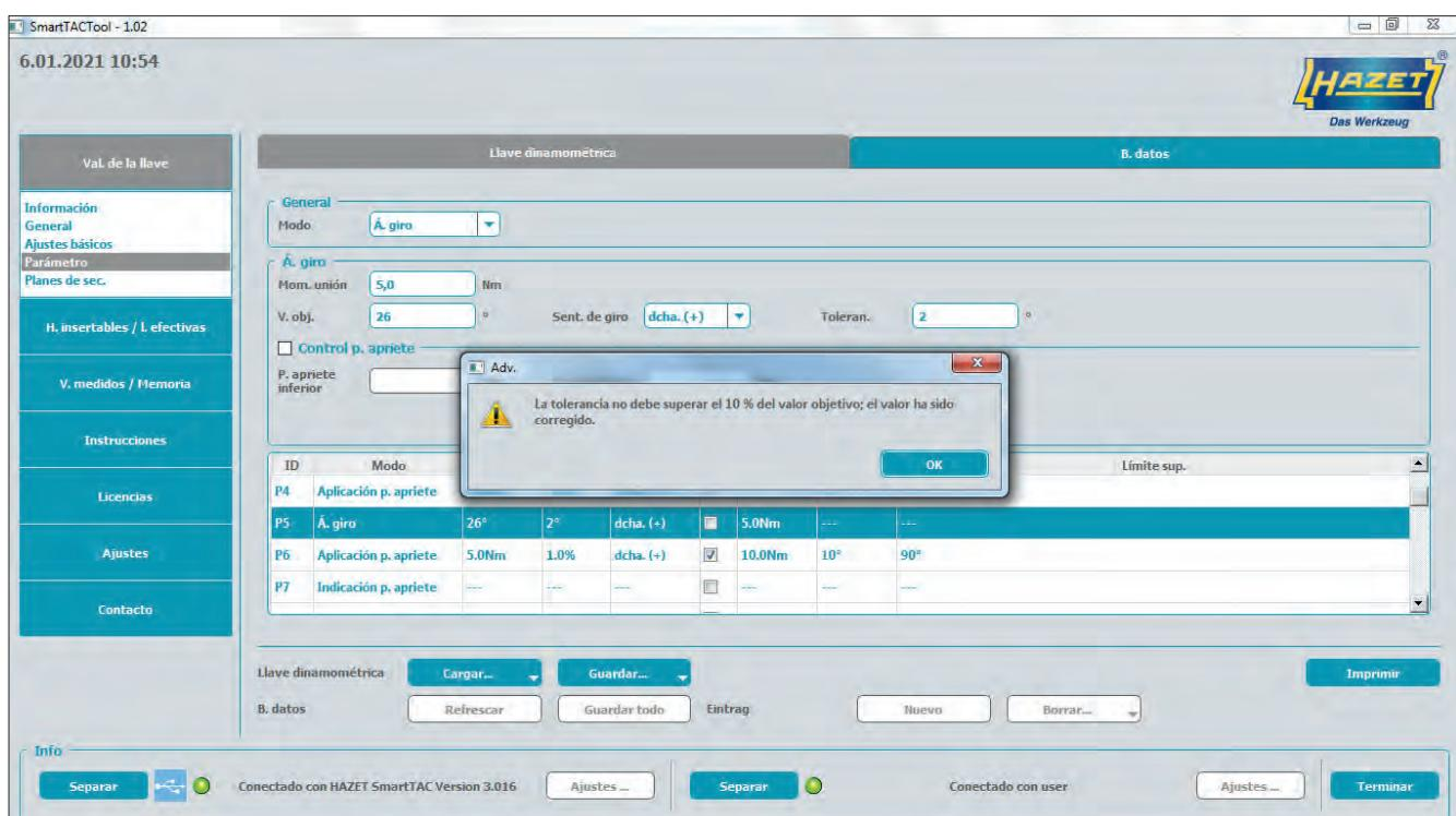
Si se excede el rango permitido al introducir un valor, se visualiza automáticamente un mensaje de error y se corrige el valor.
