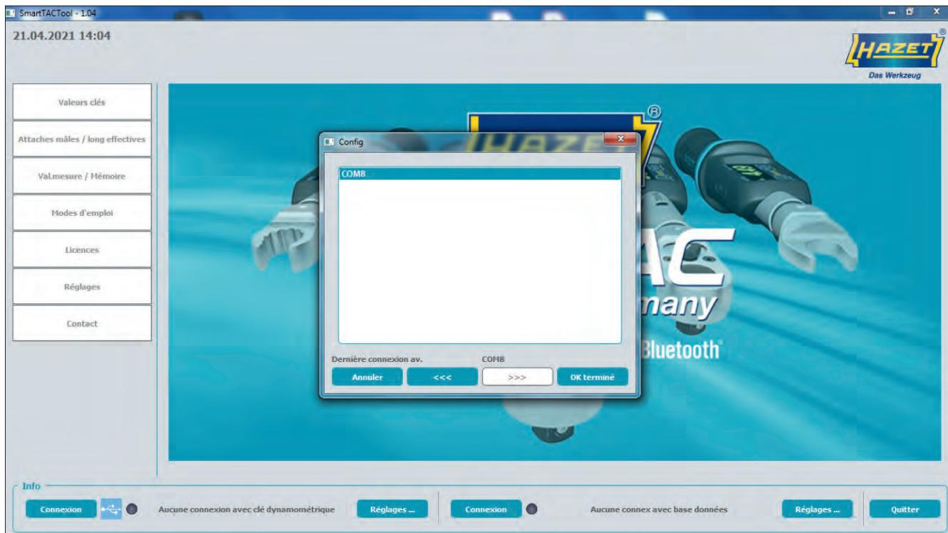
Sélectionnez le port USB correspondant par le biais duquel vous voulez connecter la clé dynamométrique à serrage couple et angle HAZET SmartTAC.
