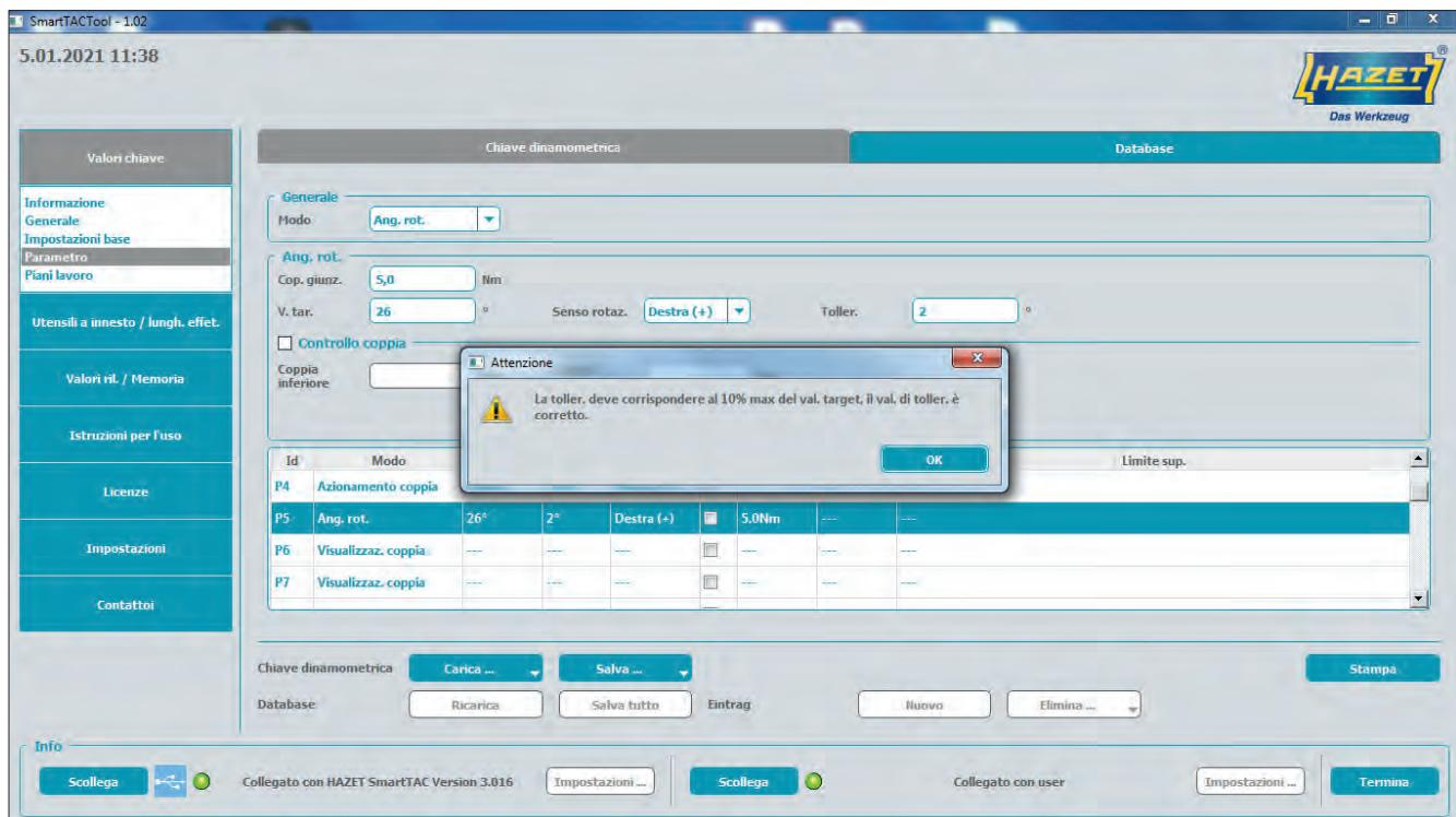
Se durante l'inserimento di un valore l'intervallo consentito viene superato, viene visualizzato automaticamente il messaggio di errore e il valore viene corretto.
