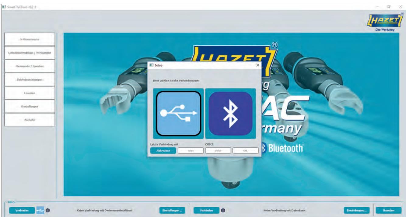
Starten Sie die Anwendung. Bevor Sie die Software verwenden können, müssen Sie die Verbindung zu Ihrem HAZET SmartTAC Drehmoment- und Drehwinkelschlüssel herstellen. Wählen Sie über den Button „Einstellungen“ auf der linken Seite die Verbindungsart, um sich mit Ihren HAZET sTAC- Schlüssel zu verbinden. Sie können den HAZET SmartTAC Drehmoment- und Drehwinkelschlüssel über einen USB- Port per Kabel oder über den HAZET- Bluetooth-Dongle verbinden.
