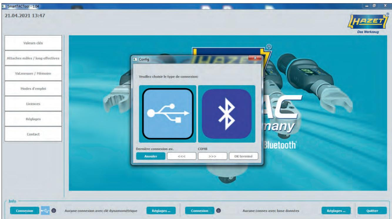
Démarrez l'application. Avant de pouvoir utiliser le logiciel, vous devez établir la connexion avec votre clé dynamométrique à serrage couple et angle HAZET SmartTAC. Sur la page de gauche, sélectionnez à l'aide du bouton « Réglages » le type de connexion que vous souhaitez utiliser pour connecter votre clé sTAC HAZET.
