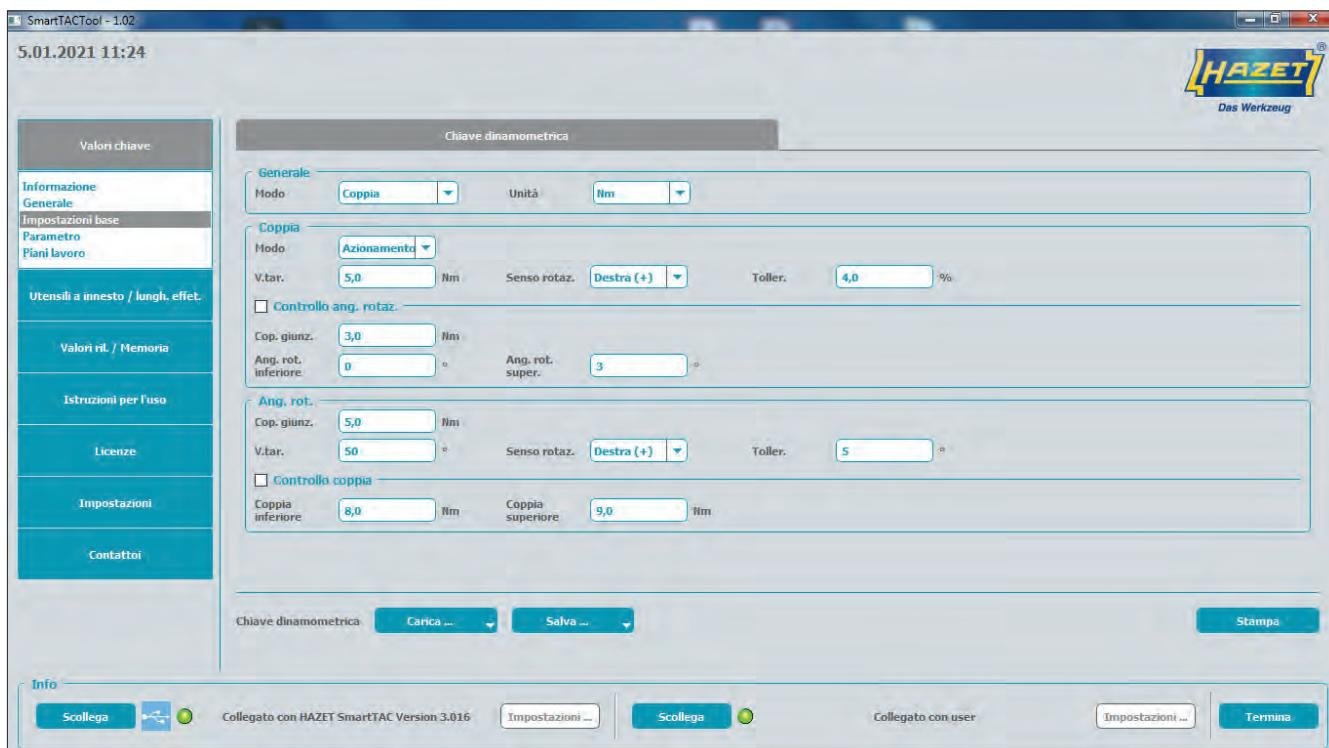
Nella tab "Impostazioni base" vengono visualizzati i valori impostati della chiave dinamometrica combinata coppia ed angolo di rotazione HAZET SmartTAC. È possibile modificarli direttamente e programmare la propria chiave dinamometrica combinata coppia ed angolo di rotazione HAZET SmartTAC per i propri impieghi lavorativi.
