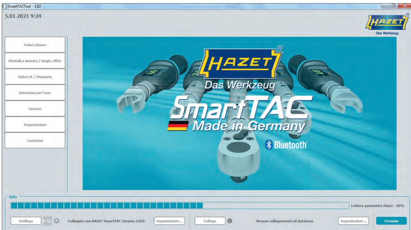
Dopo aver selezionato la porta, collegare la chiave dinamometrica combinata coppia ed angolo di rotazione HAZET SmartTAC tramite il pulsante sul lato sinistro.
