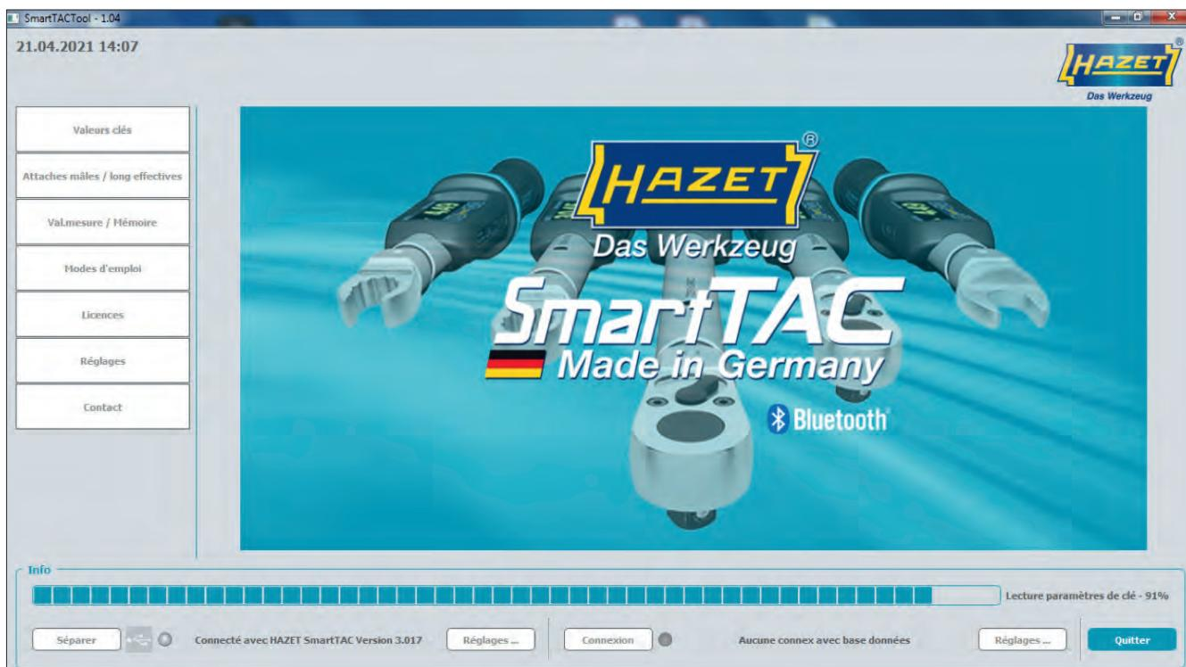
Une fois le port sélectionné, connectez votre clé dynamométrique à serrage couple et angle HAZET SmartTAC en cliquant sur le bouton de la page gauche.
