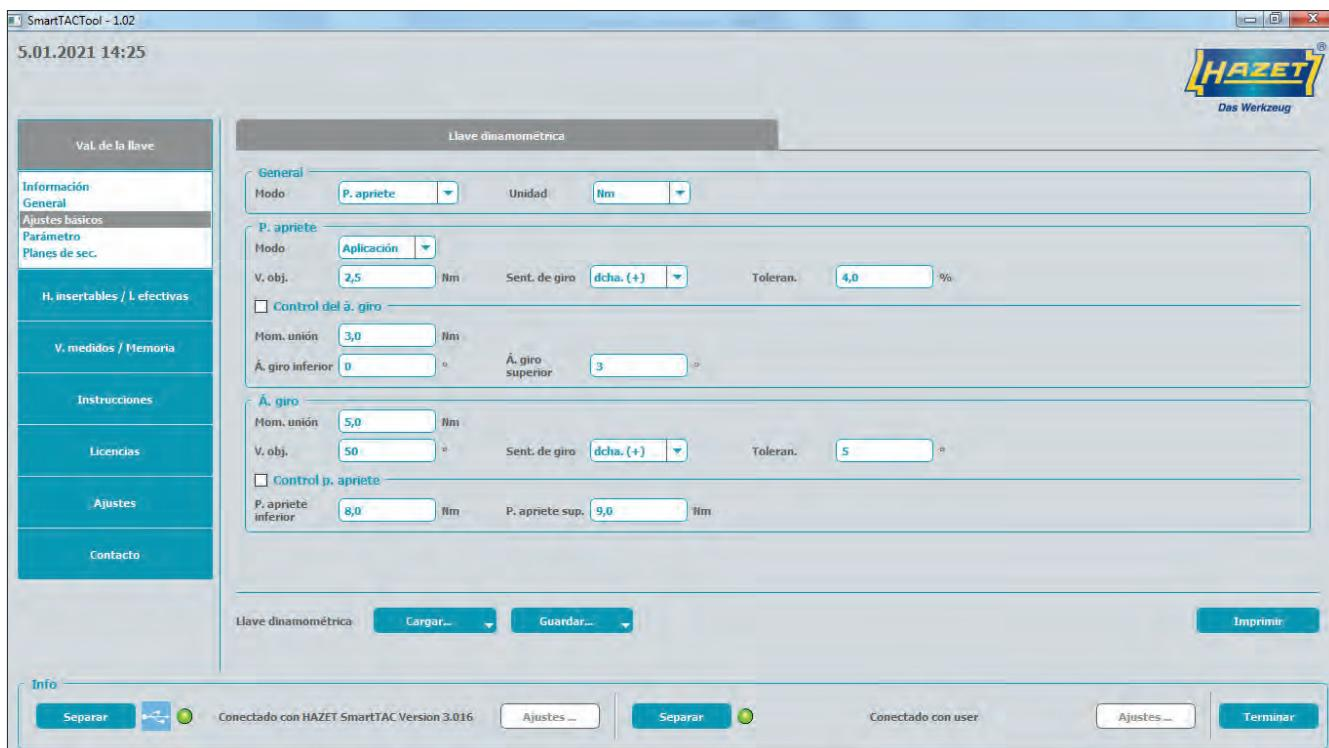
En la pestaña "Ajustes básicos", se muestran los valores de ajuste de la llave dinamométrica / medidora de ángulos de giro HAZET SmartTAC. Puede cambiarlos directamente y programar la llave dinamométrica / medidora de ángulos de giro HAZET SmartTAC para su tarea de trabajo.
