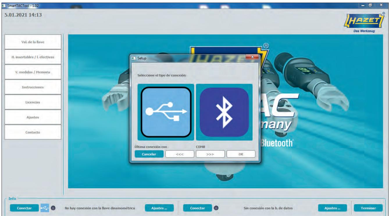
Inicie la aplicación. Antes de poder usar el software, deberá establecer la conexión con la llave dinamométrica / medidora de ángulos de giro HAZET SmartTAC. Seleccione el tipo de conexión a través del botón "Ajustes" en el lado izquierdo para conectarse a la llave HAZET sTAC.
